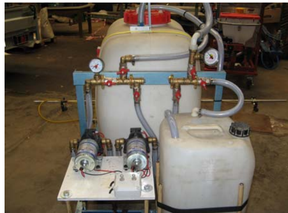
Het demotoestel heeft 2 pompen (1 hoofdpomp en 1 voor de schoonwatertank) (Bron: POVLT)
