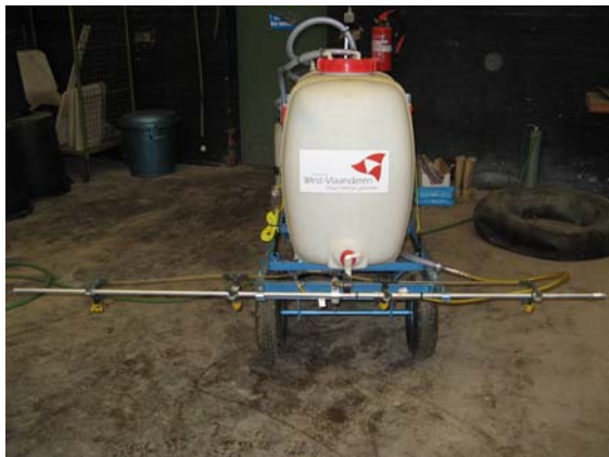
Demo spuittoestel om de continue spoelmethode te demonstreren (Bron: POVLT)
