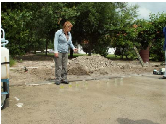
Staalname van de verdunde spuitoplossing gebeurt om de 30 seconden zodat de vermindering van de kleur kan worden aangetoond. (Bron: POVLT)
