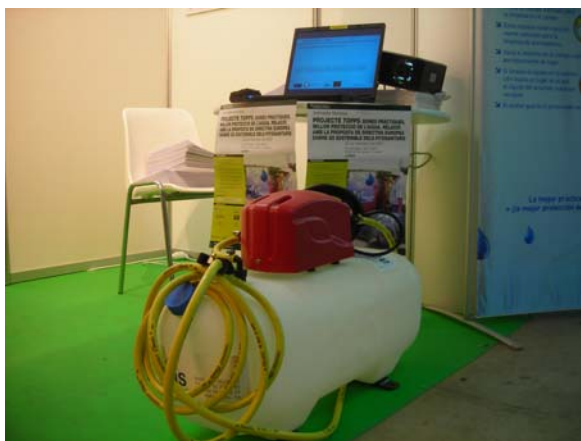
Schoonwatertank met een lans voor externe reiniging van het spuittoestel. (Bron: UPC)
